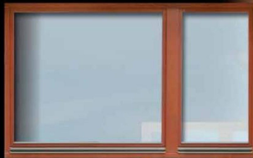
TROJKŘÍDLÉ OKNO meranti fixní – lazura otvíravé / vyklápěcí mikroventilace pojistky proti svěšení, vloupání sklo Ug 1,1 vč. nerez. rámečku rámová a křídlová okapnice
