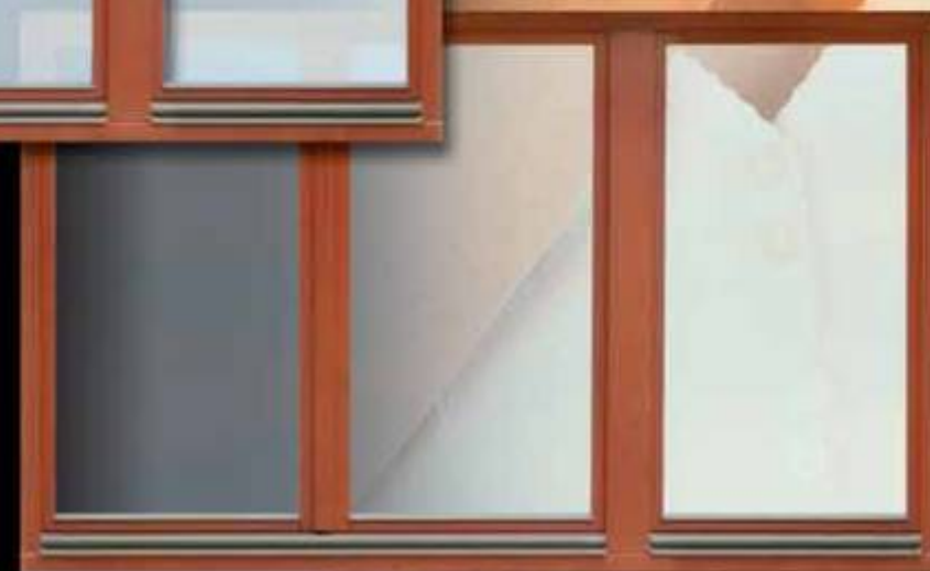
TROJKŘÍDLÉ OKNO meranti fixní – lazura otvíravé / vyklápěcí mikroventilace pojistky proti svěšení, vloupání sklo Ug 1,1 vč. nerez. rámečku rámová a křídlová okapnice
