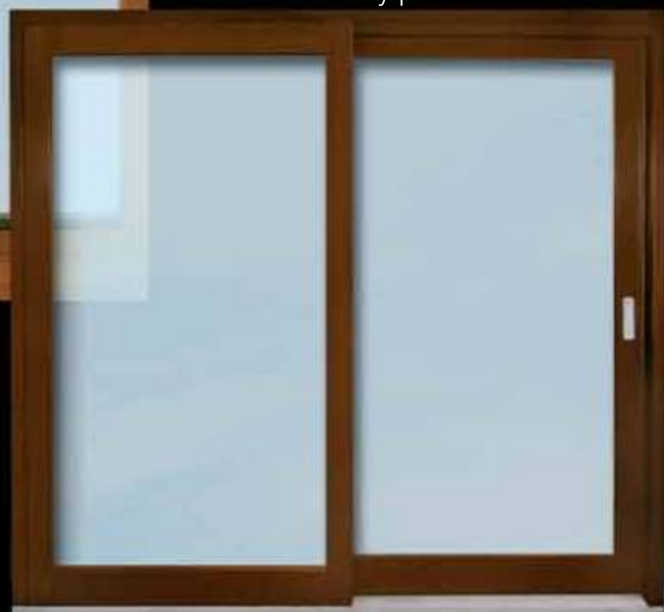
HS PORTÁL – POSUVNÉ DVEŘE max. rozměry 5000 x 2500 mm meranti fixní – lazura posuvné sklo Ug 1,1 vč. nerez. rámečku termo-hliníkový práh
