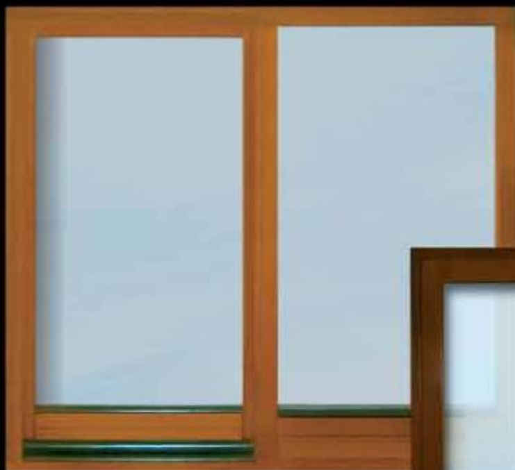
BALKONOVÉ POSUVNÉ DVEŘE max. rozměry 3000 x 2400 mm meranti fixní – lazura posuvné / vyklápěcí mikroventilace pojistky proti svěšení, vloupání sklo Ug 1,1 vč. nerez. rámečku rámová a křídlová okapnice
