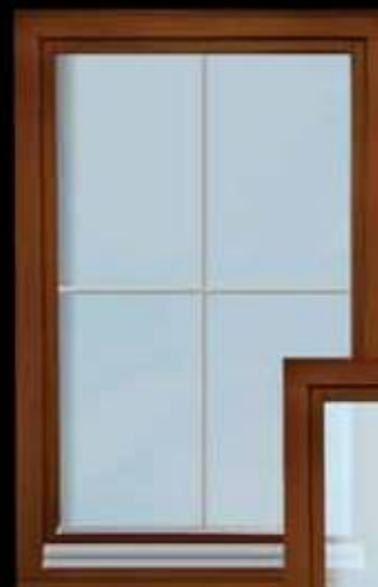
JEDNOKŘÍDLÉ OKNO meranti fixní – lazura otvíravé / vyklápěcí mikroventilace pojistky proti svěšení, vloupání sklo Ug 1,1 vč. nerez. rámečku rámová a křídlová okapnice meziskelní příčky
