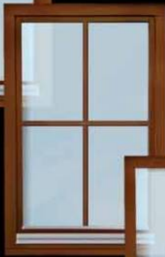
JEDNOKŘÍDLÉ OKNO meranti fixní – lazura pevné zasklení sklo Ug 1,1 vč. nerez. rámečku křídlová okapnice
