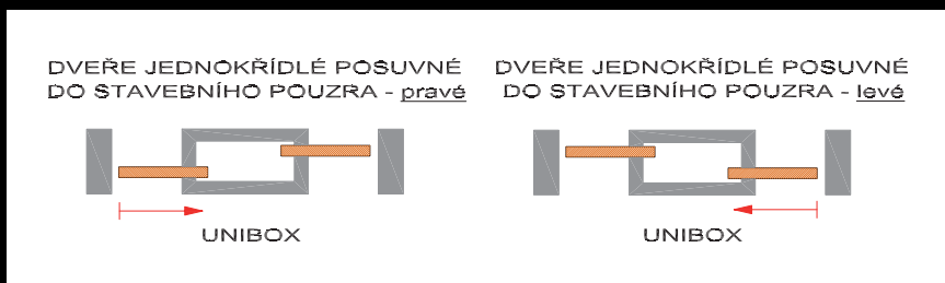
Horizontální řez pouzrem Unibox
